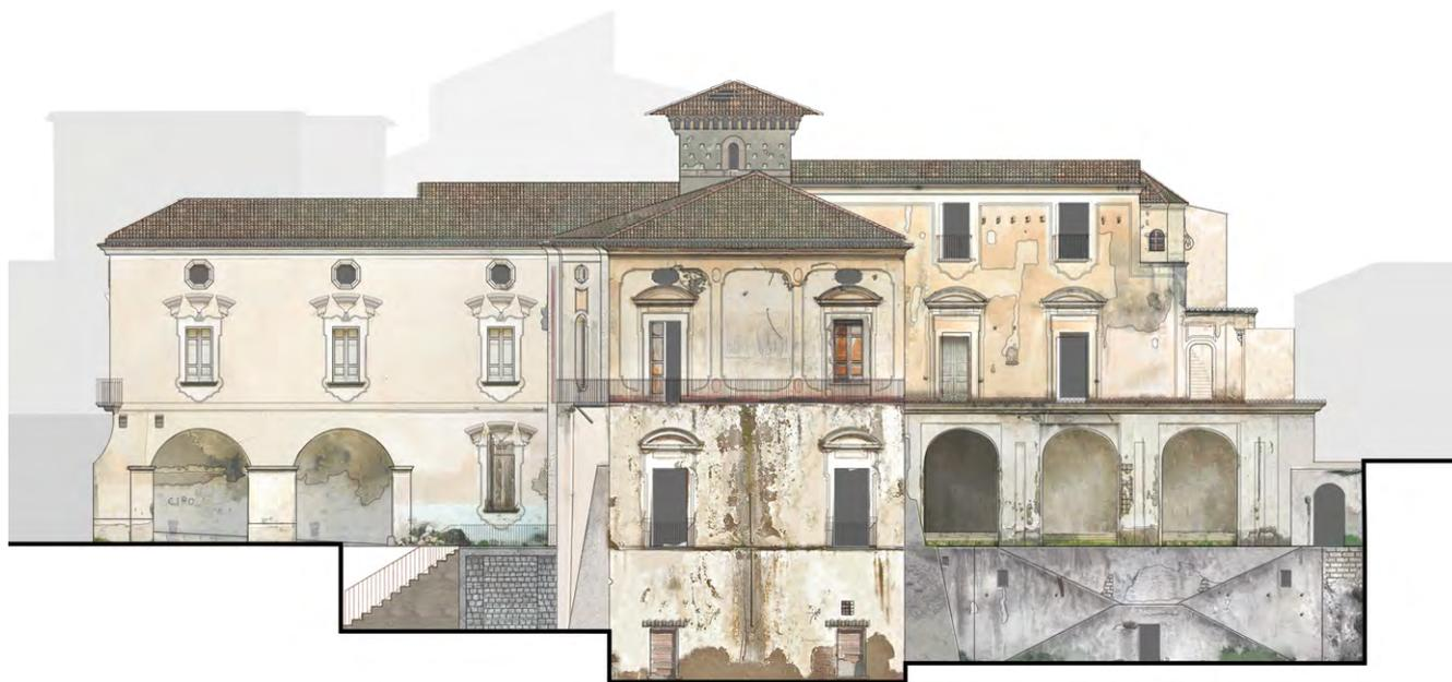
Figura 1 - Rilievo materico del prospetto sud di Villa della Rocca elaborato mediante fotogrammetria.
